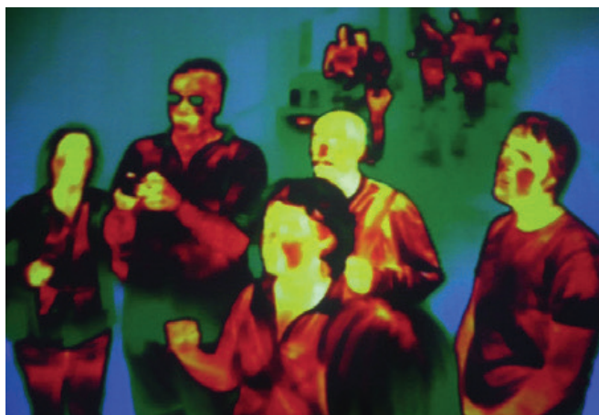
Рис. 6.5. Инфракрасное изображение, полученное в темноте. Более яркие цвета обозначают относительно более высокие интенсивности
